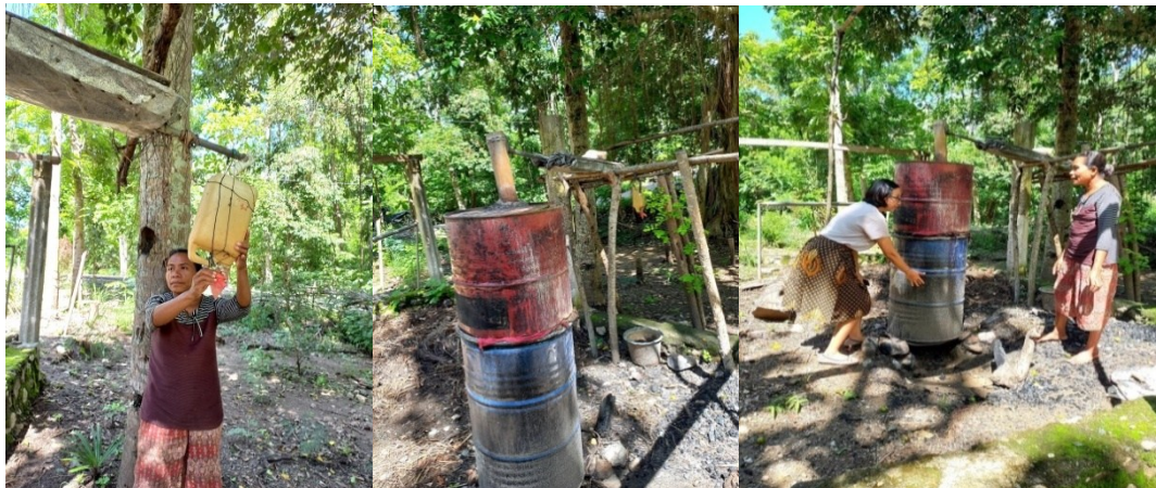
Figur 1. Model Alat Penyulingan Konvensional Kelompok Tani Gema Industri
